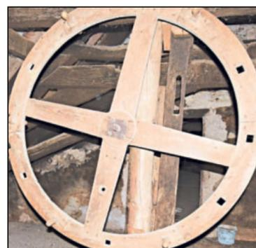
Auf dem Dachboden gibt es diese alte Hebe-Vorrichtung für schwere Lasten.
